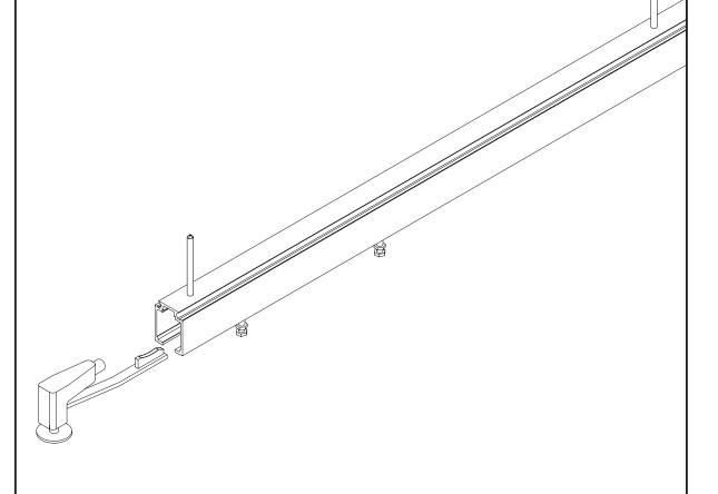
PLACER LES BUTÉES À GAUCHE ET A DROITE DU RAIL. LE RÉGLAGE SE FERA ULTÉRIEUEMENT.
